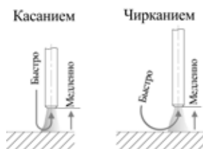
Рис. 7.2. Способы зажигания сварочной дуги.
